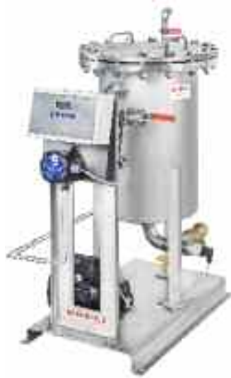
Um die Anforderungen der VDI 2035 zur Verminderung der Steinbildung zu erfüllen, ist es oft nötig, die Härte ganz oder teilweise zu entfernen. Möglich wird dies durch einen Heizungswasserfilter mit gleichzeitiger Enthärtung, etwa durch den „BerkeSelect 2035“. (Werkfotos)
