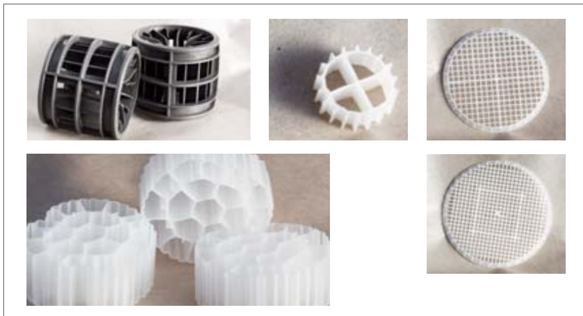
Bild 1: Trägerkörper für das AnoxKaldnes-MBBR-Verfahren
